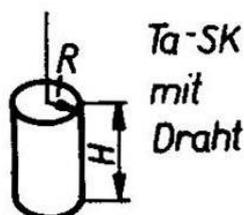
Bild 3: Geometrie des Sinterkörpers (poröse Anode)
